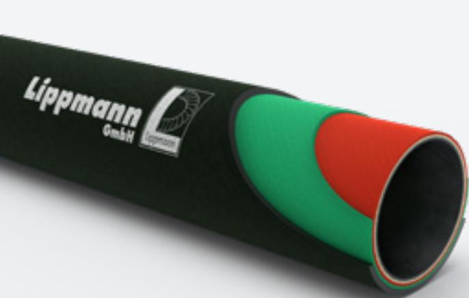
Der Ampeleffekt ist eine Art Frühwarnsystem, mit dem der Verschleiß der Außenschichten optisch kontrolliert werden kann. Erst wenn die rote Gummischicht sichtbar wird, muss der Protector™ Typ Abrasiv III aus Sicherheitsgründen ausgewechselt werden. Durch die Farben grün und rot ist es für die Instandhaltung leicht zu erkennen, wann der Protector™ Abrasiv Typ III zu ersetzen ist.
